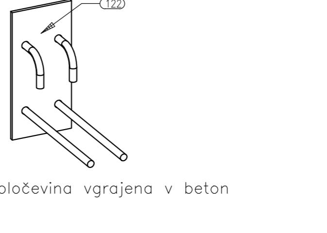
Kalibrirna pločevina vgrajena v beton
